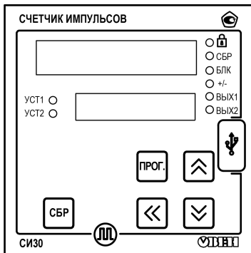
Рисунок 6.2 – Лицевая панель прибора для корпусов настенного Н и щитового Щ1 крепления
